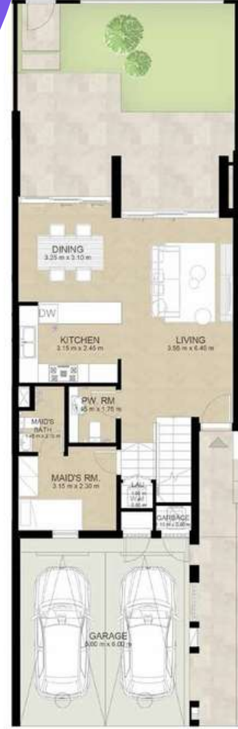
GROUND LEVEL الطابق الأرضي
